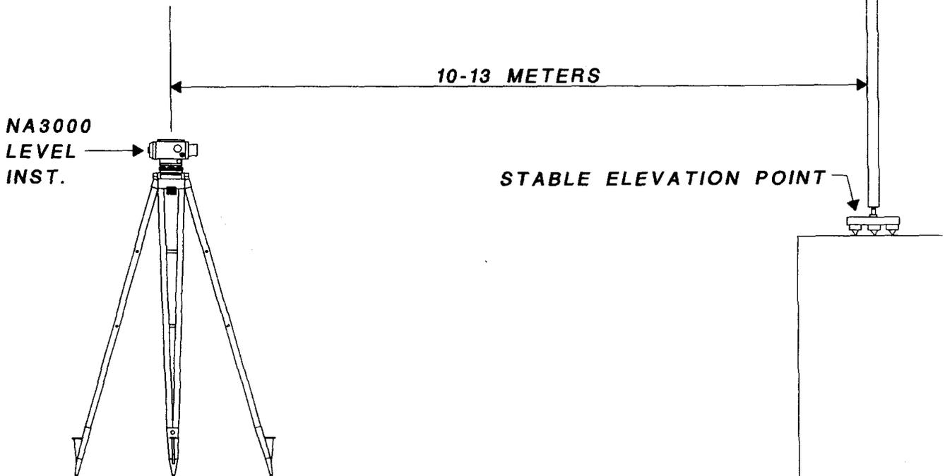
**USING LEICA'S 60 CM INVAR LEVELING STRIP
